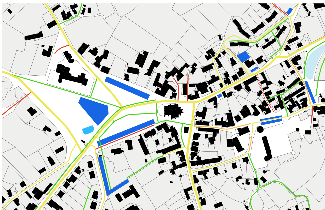
Schéma d'organisation des stationnement, de la circulation et du maillage piéton dans le centre bourg d'Assier. Source : ADR.
